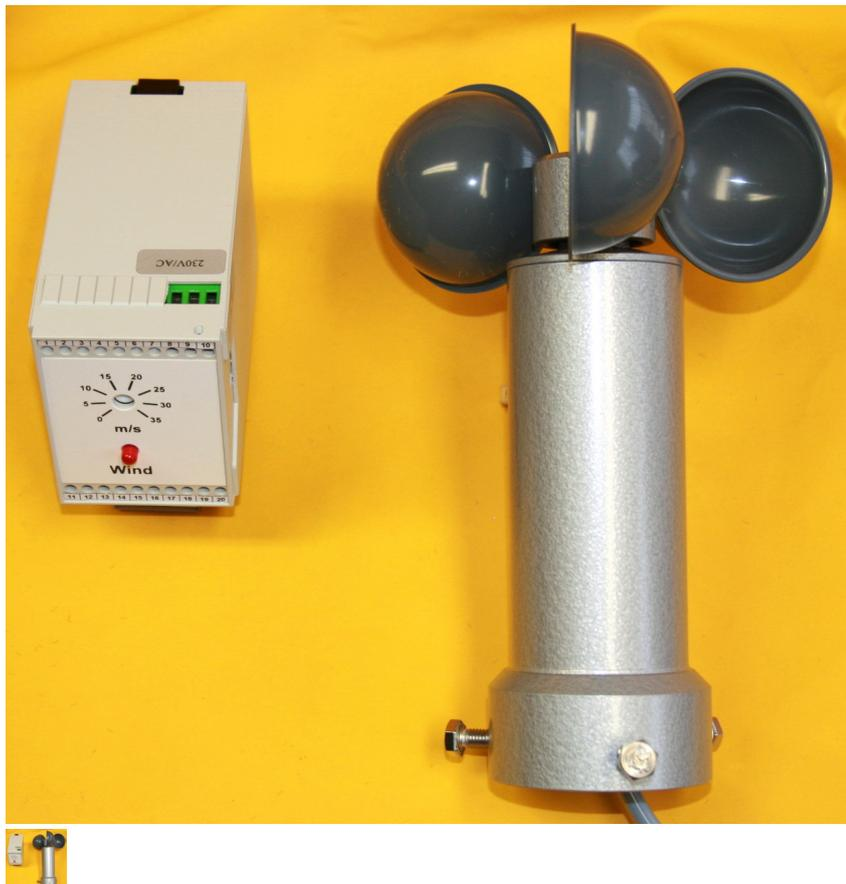
Windwächter / Windwarngerät mit sep. Steuergerät für Hutschienenmontage Schaltpunkt einstellbar 0...35 m/s Ausgang potentialfreier Wechsler Betriebsspannung 24V AC/DC
